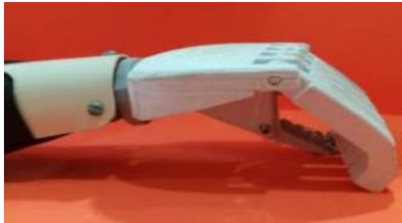
Figura 4: Prótese parcial de mão com acionamento a partir da extensão de punho.
