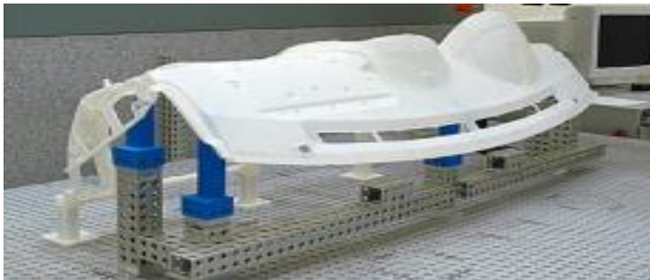
Figura 3 – Protótipo fabricado em manufatura aditiva em tamanho real do painel do veículo Hyundai Kia Spectra
