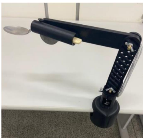
Figura 7 – Dispositivo para permitir alimentação em pessoas com lesão medular.
